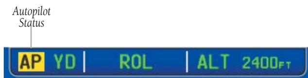
**Autopilot Manually Disengaged**
